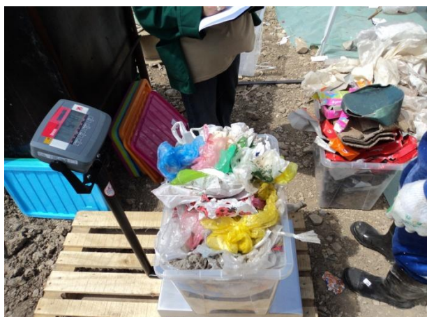
Slika 1: Elektronska vaga korištena u ispitivanju sastava otpada na primjernoj regionalnoj deponiji, Maj 2010
