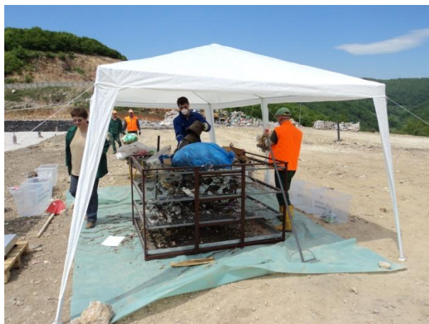
Slika 4: Proces sortiranja otpada u cilju ispitivanja njegove strukture, Regionalna deponija, Maj 2010
