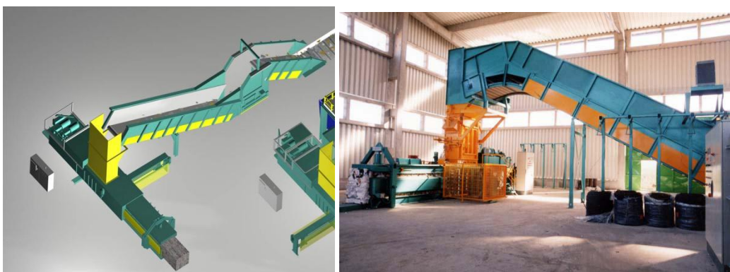
Ilustracija 14: Napojni transporter uređaja za baliranje reciklažnog materijala
